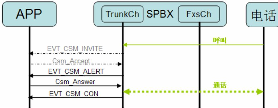
6、 Demo 程序申请 RP 媒体资源， 并连接两个通道的 SS 端口； 连接建立后， 播放提示音并接收按键；
