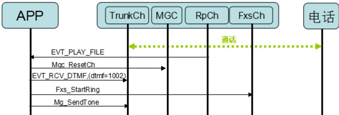
8、 FXS 通道的 A 分机接听后， 系统停止向主叫发送回铃音， 并连接 FXS 通道和主叫；
