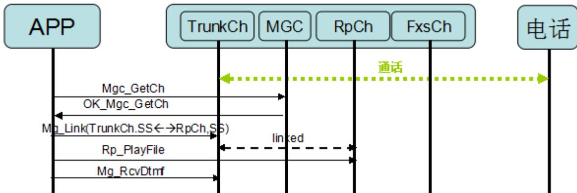
7、 收到按键后， Demo 程序停止播放提示音， 并释放放音资源， 同时根据接收到的按键查询分机对应的 FXS 通道， 对 FXS 通道的 A 分机振铃， 并向主叫发送回铃音；
