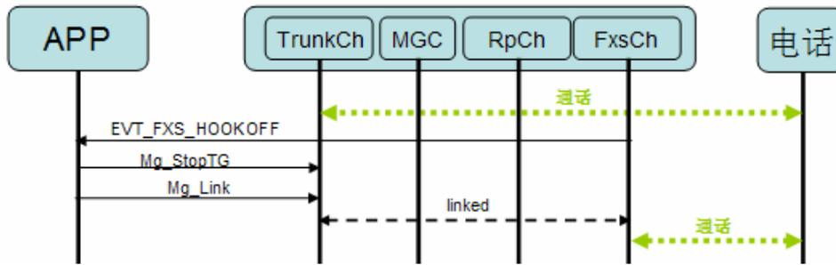
9、 A 分机进行闪断操作，随后按下 B 分机的分机号（如：1003）并以#号键结束；Demo 程序呼叫 B 分机，等待 B 分机摘机后，连接 B 分机和 Trunk 通道；
